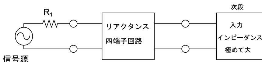
信号源の内部抵抗が  $R_1$ 、次段の入カインピーダンスが極めて大きいので、リアクタンス四端子回路の出力は、開放と見なせる場合のフィルターです。R-∞型と呼びます。下图のようにリアクタンス四端子回路の手前に、 $R_1$ の四端子回路がつながっていると考えます。
