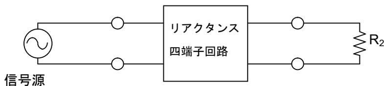
信号源の内部抵抗が0、フィルターの負荷を  $R_2$  とした場合のフィルターです。 $R_2$  が負荷抵抗ですから、 $R_2$  より右側は高インピーダンス回路がつながっています。
