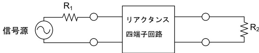
信号源の内部抵抗を R<sub>1</sub>、フィルターの負荷を R<sub>2</sub> とした場合のフィルターです。R<sub>2</sub> が負荷抵抗ですから、R<sub>2</sub> より右側は高インピーダンス回路がつながっています。
